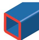
**Прочность конструкции** — рама изготовлена из стали 09Г2С, 150x150x12 (ПНГ-8-50К, ПНГ-6-50К).
