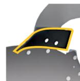
**Оборудованы углоснимками,** которые выполняют функцию предплужников и укладывают пласт почвы на дно борозды.
